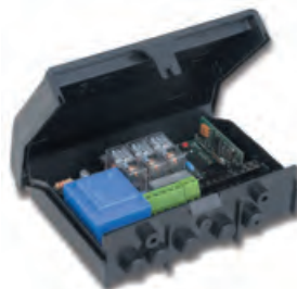
11708000 Einfache vollwertige elektronische Steuerung für einen 230 V Motor max. 600 W mit eingebautem Funkempfänger 1-Kanal im Außengehäuse IP55, 20 Sender speicherbar, eine Lichtschranke anschließbar, Impulssteuerung mit Selbsthaltung und einstellbarer Selbstschließung, Größe 140x120x50mm.
