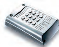
14244914 Funknummernschloß 4-Kanal mit 1 Mio Kombinationsmöglichkeiten, im Gehäuse IP57 aus schlagfestem Kunststoff, bis 250 Codes speicherbar, Verwaltung von 4 unterschiedlichen Funktionen, kommuniziert kabellos mit allen Empfängern dieses Funksystems, Stromversorgung 6 V durch zwei Lithiumbatterien, Größe 72x115x28mm
