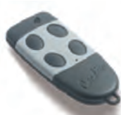
12511104 Funkhandsender 4-Kanal Gehäuse aus schlagfestem Kunststoff, Stromversorgung 6 V durch zwei Lithiumbatterien, Größe 34x72x11 mm
