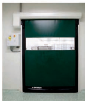
D-311 Cleanroom LF Max. Abmessungen: B 4.000 x H 4.000 mm INNENTOR - Schwerkraft - Sanfter Abschlusssack - Öffnungsgeschwindigkeit: 1,2 m/s - Schließgeschwindigkeit: 0,5 m/s - Frequenzumrichter - erfüllt EN 13241-1
