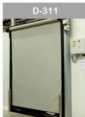
D-311 LF Max. Abmessungen: B 4.000 x H 4.000 mm INNENTOR - Schwerkraft - Sanfter Abschlusssack - Öffnungsgeschwindigkeit: 1,2 m/s - Schließgeschwindigkeit: 0,5 m/s - Frequenzumrichter - erfüllt EN 13241-1
